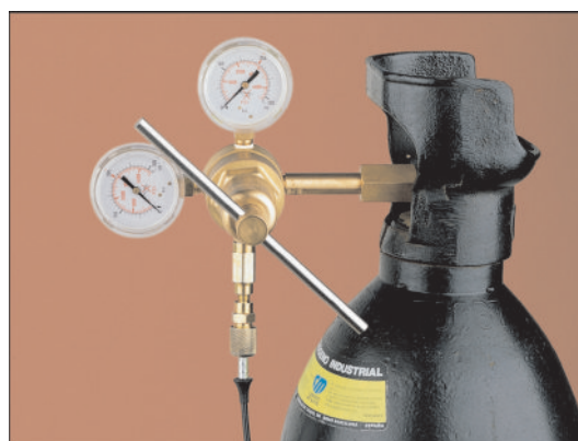
Regulador de presión. Pressure regulator.
